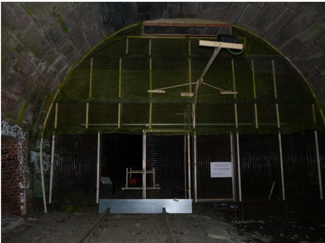
Abbildung 3: Vergittertes Tunnelportal Ostelsheim mit deckennaher Lichtschanke und Foto-Monitoring-Einheit.
